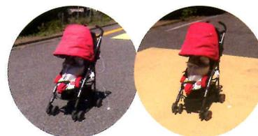
▶同時に計測したベビーカー内の温度も最大 4.6°Cもの温度差！(未塗装路面上 45.3°C、遮熱アイボリー塗装面上 40.7°C。路面より60cmの高さで計測)。大人より路面に近い幼い子どもを暑さから守ります！！
